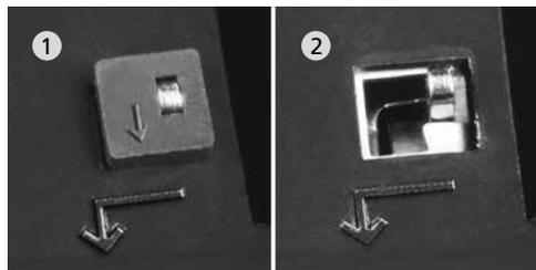
2. Entfernen Sie die kleine schwarze Kunststoffkappe, die sich direkt unterhalb des silbernen Pins im Oberteil befindet (Abb. 1).
