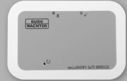
Mit der secuENTRY 5670 BRIDGE haben Sie die Möglichkeit secuENTRY Zylinder über eine Internetverbindung in Kombination mit der secuENTRY BURGsmart App aus der Ferne zu administrieren. Dies beinhaltet die Übertragung von Konfigurationsfiles, Fernöffnung und zusätzlich die Erstellung von zeitlich limitierten Zutrittscodes\* für secuENTRY PRO Zylinder und Relay.
